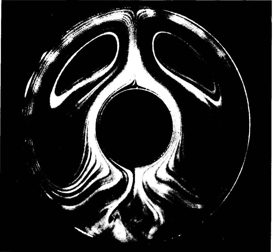
fig. 2 - Expérience de Bénard : fumée de cigarette entre deux cylindres en rotation (O.N.É.R.A.).
